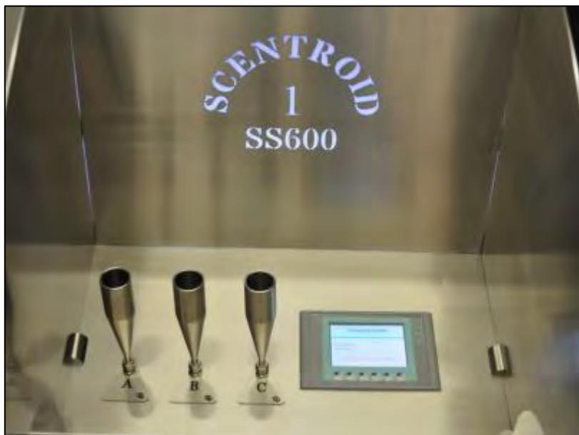
Figura 5. Olfattometro Scentroid mod. SS600 – postazione valutatore
