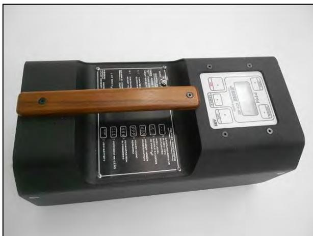
Figura 6. Analizzatore portatile di  $H_2S$  Jerome 631-XE
