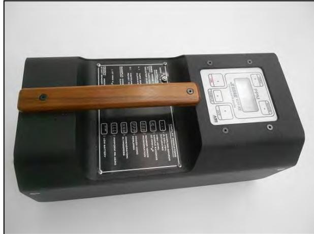
Figura 7. Analizzatore portatile di  $H_2S$  Jerome 631-XE
